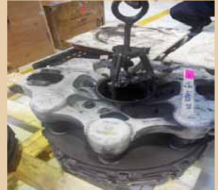
Brake Unit siap diangkat menggunakan Crane
