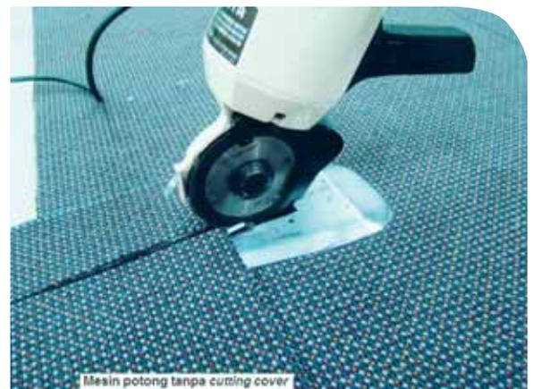
Seorang pekerja telah mengalami kecelakaan kerja karena memakai mesin pemotong tanpa *cutting cover*.
