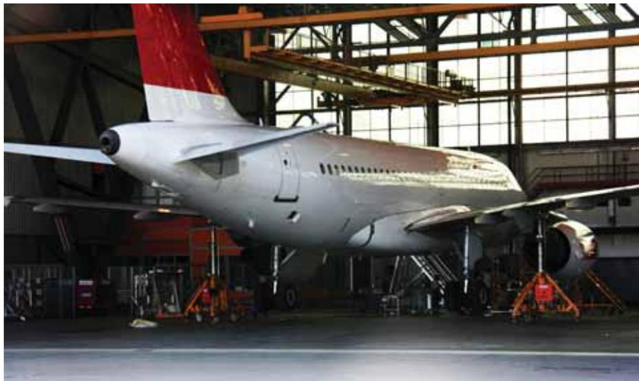
Beberapa orang teknisi di sebuah hangar perawatan pesawat mendorong jack pesawat ke lokasi tertentu. Sebagian teknisi menyiapkan *hydraulic pump* dan *hydraulic fluid*-nya sebagai persiapan melakukan *hydraulic fluid green system replenish* pada pesawat A319. Pesawat dijadwalkan tiba di hangar pukul tujuh malam. Tapi, pesawat baru
