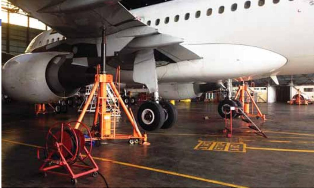
*main landing gear*". Istilah-istilah yang tidak konsisten dan saling berurutan ini menyebabkan engineer memiliki persepsi yang dimaksud dengan "*safety stay*" adalah *landing gear ground lock pin*. Akibatnya *tail jack* tidak dilepas pada saat pelaksanaan *up down check* yang mengakibatkan terjadi kerutan (*wrinkle*) pada area ekor pesawat.
