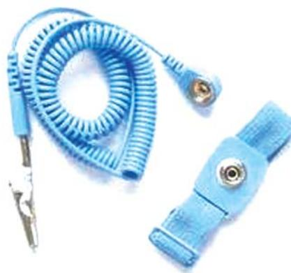
Wrist Strap memiliki dua komponen utama yakni gelang yang melingkari pergelangan tangan dan kabel yang menghubungkan gelang dengan common point ground. Wrist strap memiliki resistor (tahanan) pembatas tegangan yang berfungsi untuk melindungi personel dari kejutan listrik jika alat ini tidak sengaja teraliri arus listrik secara langsung. Agar wrist strap tetap berfungsi secara optimal, mak harus diuji dan diinspeksi secara berkala.
