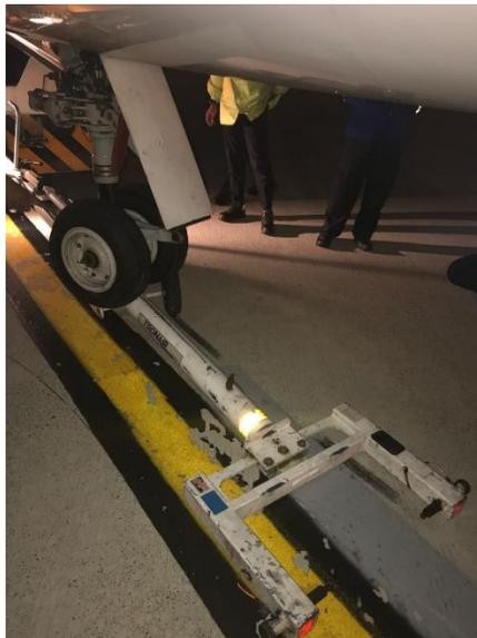
Kejadian tersebut karena kegagalan *locking system* di *axle engagement pin* pada *towing bar*. Akibat dari kejadian itu pesawat tersebut menghadapi resiko yang berat yaitu harus dilakukan penggantian *nose landing gear*.
