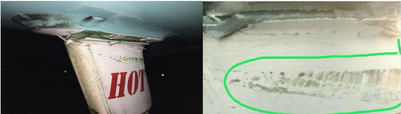
Gambar 1. Kondisi Drain Mast PK-GRF Damage di Sta. Tambolaka (TMC)
