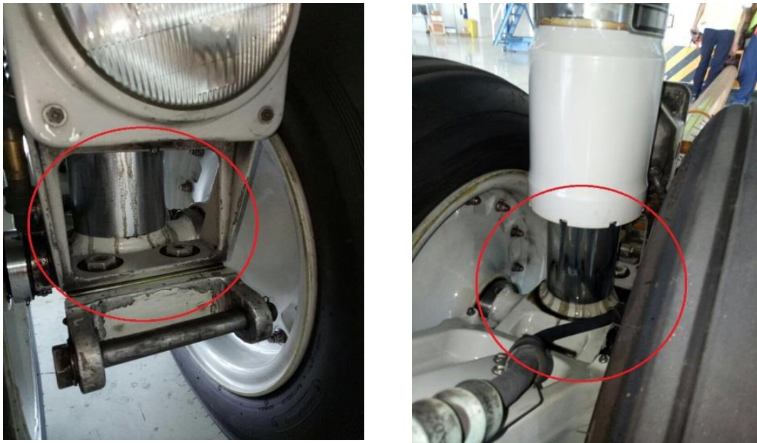
Gambar 1. Leak pada area shock strut nose landing gear
